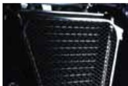
Un radiatore di ampie dimensioni e di efficiente forma trapezoidale, sviluppato per le **moto** di gara, consente di mantenere temperature del motore stabili, contribuendo all'efficienza della combustione e a una produzione di potenza uniforme, permettendo inoltre l'uso di una carrozzeria più sottile per un migliore risultato aerodinamico della **Gsx R 1000 k9**.
