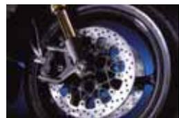
L'impianto frenante anteriore della **Gsx R 1000 k9** associa dischi flottanti da 310 mm con pinze a montaggio radiale.
